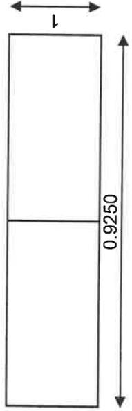
ferestre cu geam termopan o deschidere oscilobatanta
